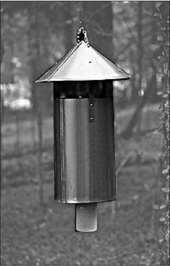
Az árvaszúnyog rajzások nyomon követésére használt New Jersey típusú fénycsapda
